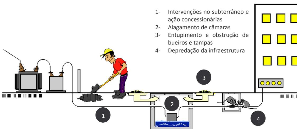
O compartilhamento do subsolo, apesar da separação das redes, propicia que gases escoem pelo subsolo e adentram nas instalações subterrâneas, a despeito dos esforços para isolamento e impermeabilização das estruturas por parte das concessionárias. Por essa razão, a Light e a CEG (Companhia de gás canalizado) mantêm equipes mistas realizando inspeções permanentes nas CIs para identificar a eventual presença de gás natural.
